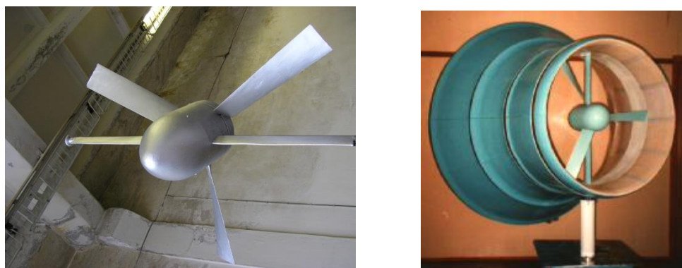
Рис.2. Лопасти, кок и диффузор энергетической ветроустановки, изготовленные из стеклопластика.
